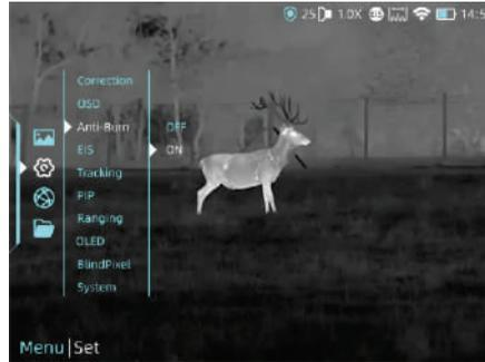
Anti-Burn-Funktion des Detektors, kann ein-/ausgeschaltet werden.
