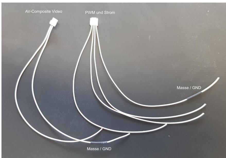
Isolieren Sie die Enden auf die gewünschte Länge ab und montieren oder löten Sie die Kabel an Ihre Videoübertragung oder Stromversorgung.
