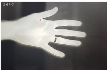
Bitte beachten Sie dass die Kamera in den ersten 2-3 Min ab Start sich zuerst aufwärmen muss. Die Temperaturen können sich in dieser Zeit um ca. 4-5° noch verändern. Die Temperaturfunktion ist aber in erster Linie zur Hotspoterkennung gedacht. Ein genaue Temperaturmessung ist nicht das Ziel. Die Messgenauigkeit ist sehr abhängig von der Flughöhe / Distanz zum Ziel.
