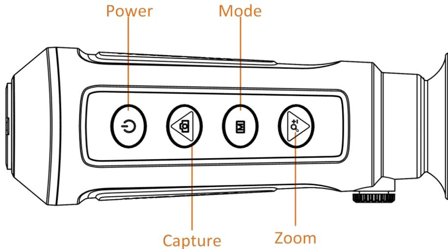
Abbildung 1-1 Tasten auf dem Gerät
